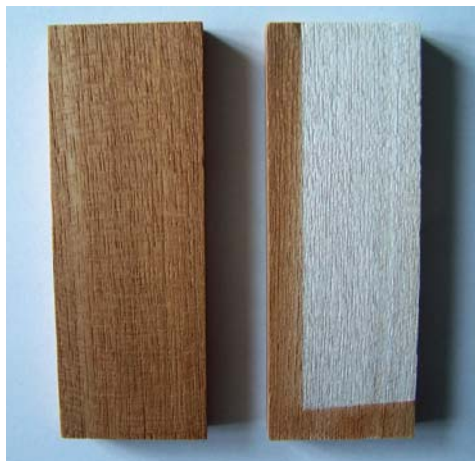
Teak nativ vor/nach 500 h Belichtung im Xenon-Testgerät:
