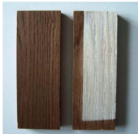
TMT Esche 200 vor/nach 500 h Belichtung im Xenon-Testgerät:
