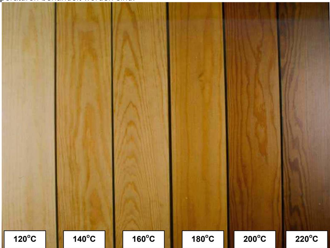
Abb. 20-4. Die Farbe der wärmebehandelten Kiefer. Die Temperaturen der Bearbeitung - von 120 bis zu 220°C, Schritt - 20°C. Bearbeitungsdauer (Photo von VTT).
